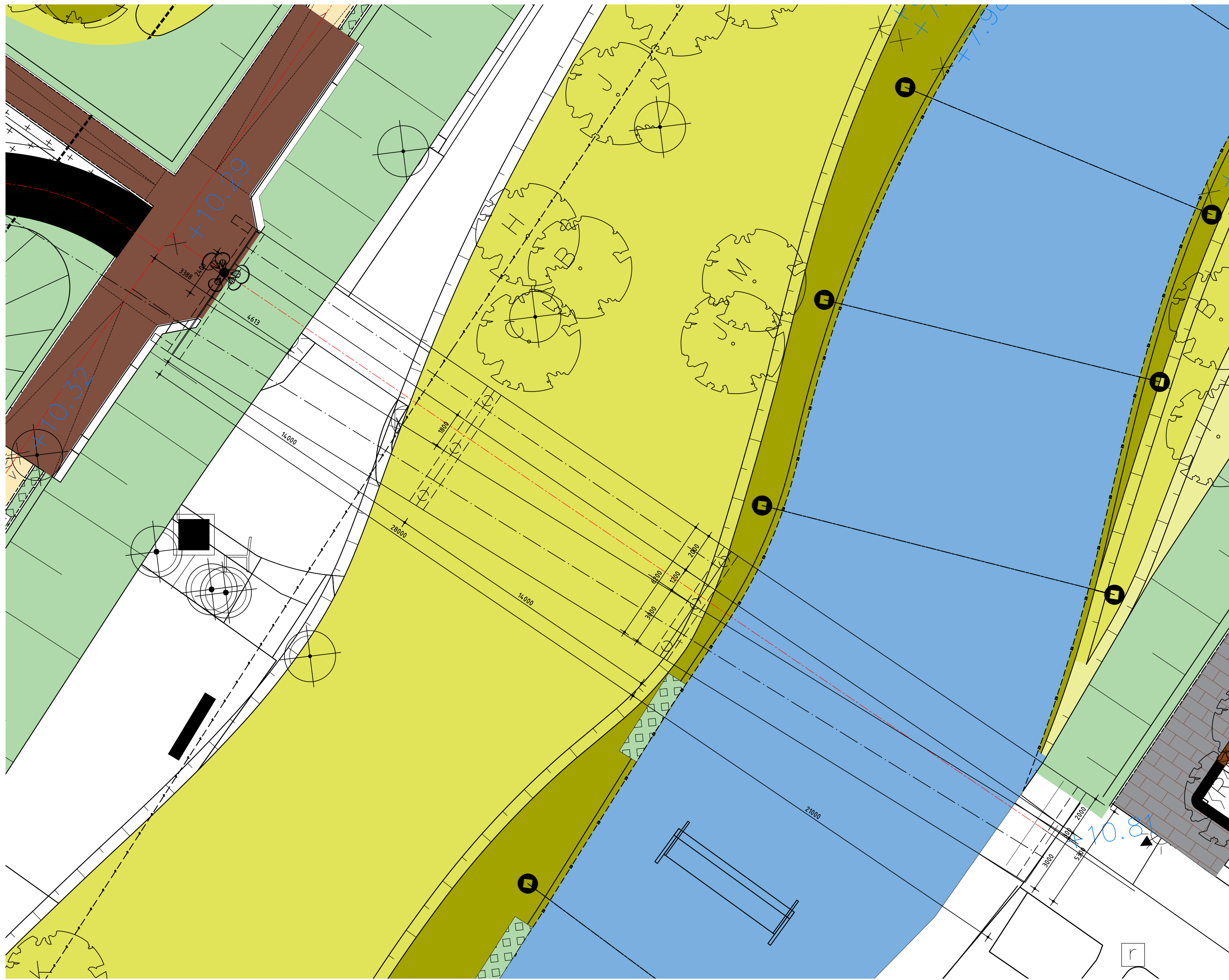
BOVENAANZICHT FIETS- VOETGANGERSBRUG NEULBRUG SCHAAL 1:100
