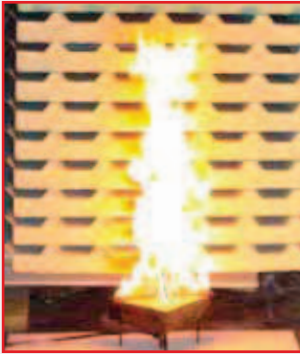
Start van de test (30 kW brander op kop paneel)
