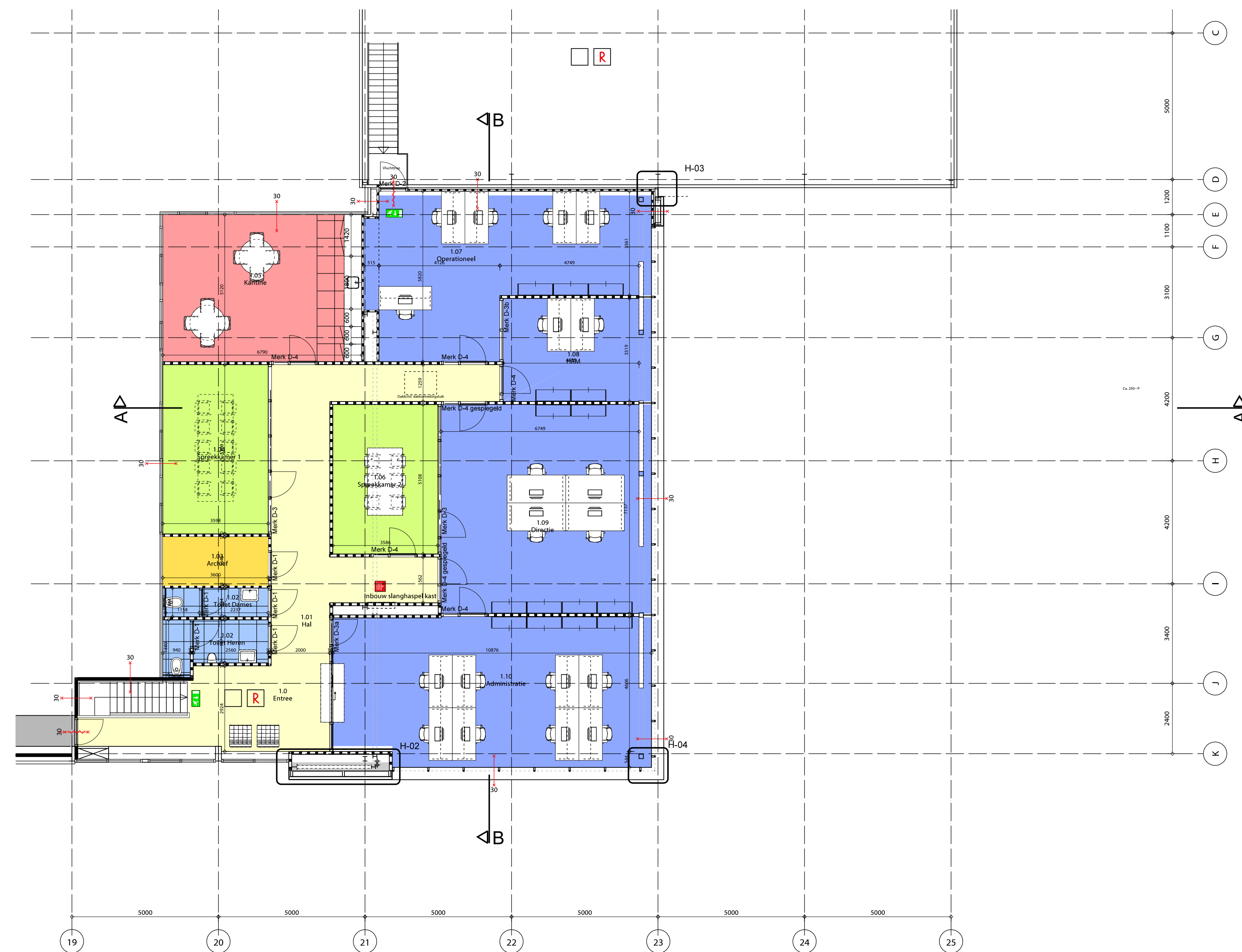
Verdieping Hoofdraagconstructie kantoor 30 min. brandwerend uitvoeren
