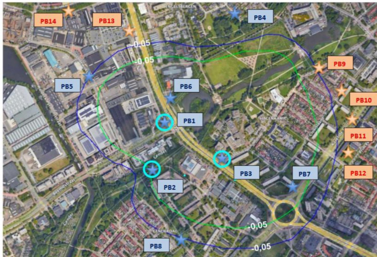
Peilbuizen voor monitoring verlaging grondwaterstand in de omgeving
