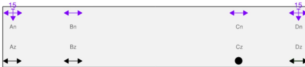
Figuur 10, oplegschema einde fase 4
