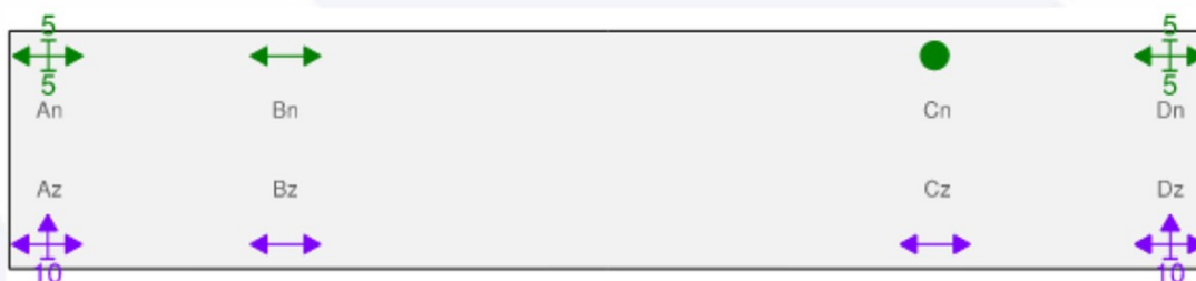
Figuur 8, oplegschema einde fase 3
