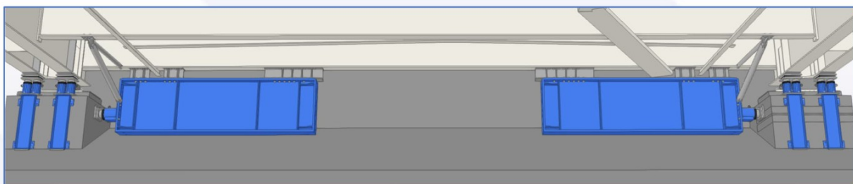
Figuur 5, vasthoudconstructie landhoofd
