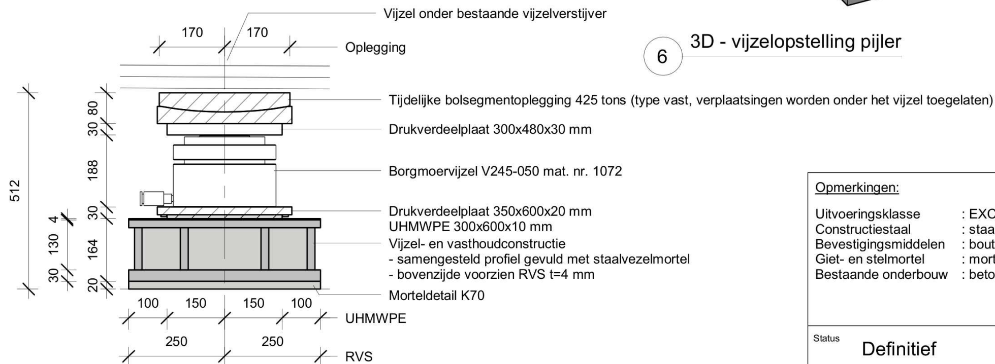
4 Zijaanzicht - vijzel pijler 1 : 10
