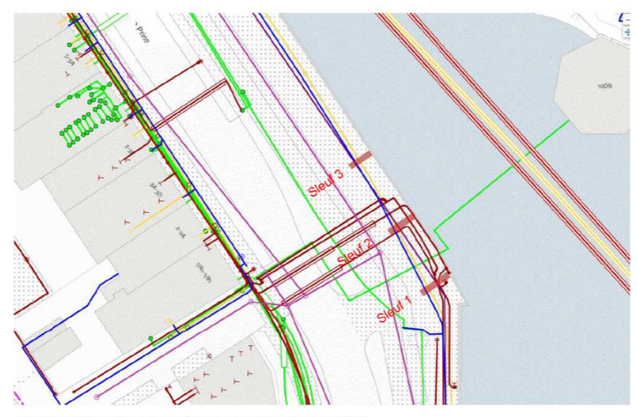
Abbeelding 22: Overzicht locaties proefsleuven op ondergrond Levering KLIC Bron: INFR240724-NOT-001-Onderzoek Herstel Prinsenkade_v1.0m
