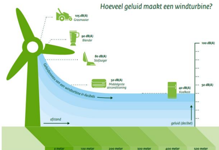
Figuur 5.1: Schematische weergave windturbinegeluid in vergelijking met andere bronnen, waarbij in werkelijkheid de geluidsniveaus per afstand en per situatie verschillen en zal het geluidniveau na 300 meter nog verder afnemen (RIVM Factsheet gezondheidseffecten van windturbinegeluid, 2021).
