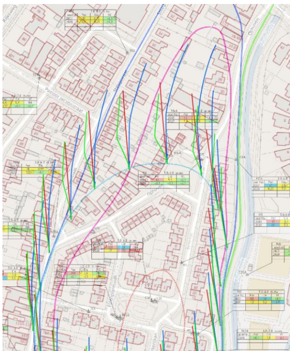
Figuur 4.8 Berekende verplaatsing van grondwaterdeeltjes startend op de tussenwaardecontour voor de duur van 60 dagen (2 meest zuidelijke trajecten). In rood zonder bemaling, in blauw de situatie met bemaling en in groen de situatie met bemaling en retourscherm.
