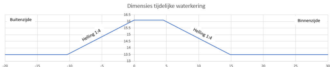
Figuur 4: dimensies tijdelijke waterkering in dwarsprofiel
