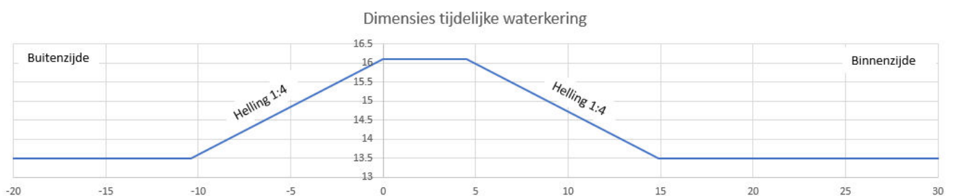
Figuur 19: dimensies tijdelijke waterkering in dwarsprofiel
