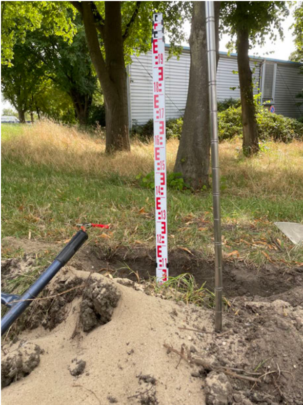
locatie proefsleuf #8 fietspad oz; zeer fijn humusarm zand in cunet langs fietspad
