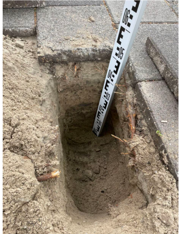
profiel #16, alleen oppervlakkige wortels (opdruk verharding)
