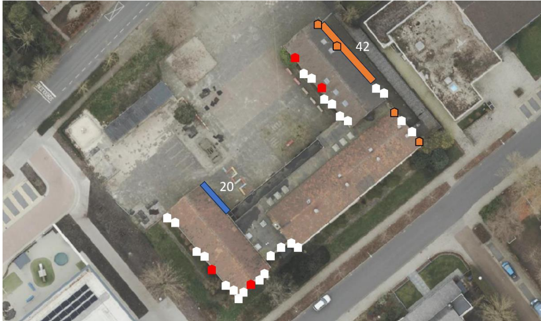
Figuur 1: de aanwezige tijdelijke mitigerende maatregelen ten behoeve van de sloop van de aanwezige bebouwing en de bouw van de nieuwe school De Regenboog te Van Sytzamalaan 1 t/m 3a, Oldebroek. Hiervoor zijn 24 reguliere vleermuiskasten opgehangen (wit), 4 kraamverblijfkasten (rood), 20 gierzwaluwkasten (blauw) en 46 huismuskasten (oranje) (ondergrond: PDOK Viewer, 2026).
