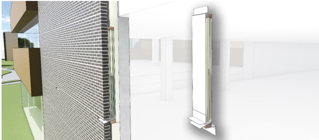
Figuur 10 Impressie van een inbouwvoorziening voor vleermuizen. Tekening: NatuurInclusief – Ecologisch advies en projectbureau
