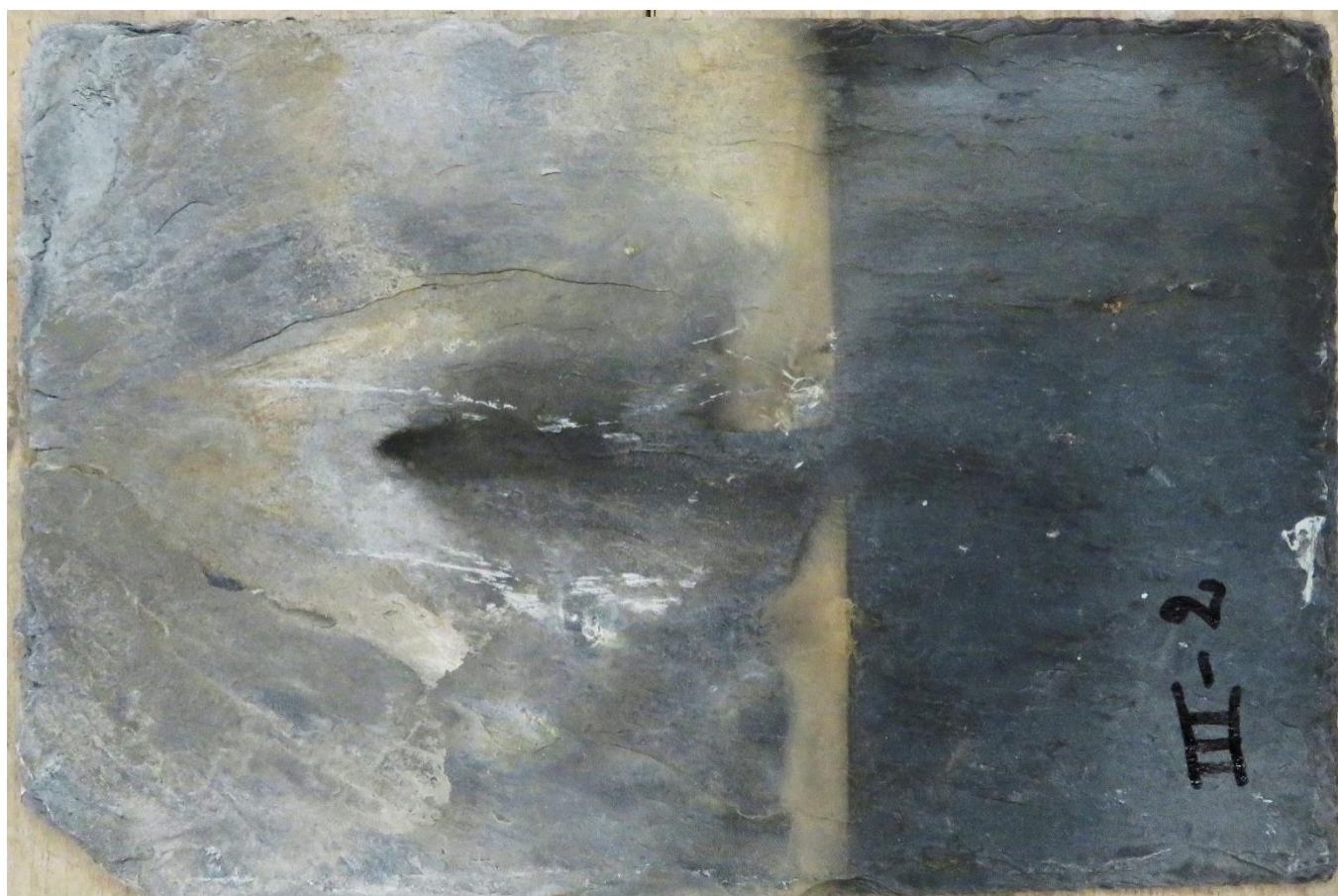
Deel III-2: Foto 13: III-2 bovenzijde. Foto 14: III-2 onderzijde Sterk verweerd (V3), randen pulverig, dof, in haak zonder uitslijting. Licht oxiderende metallieke mineralen aan onderzijde type T2.
