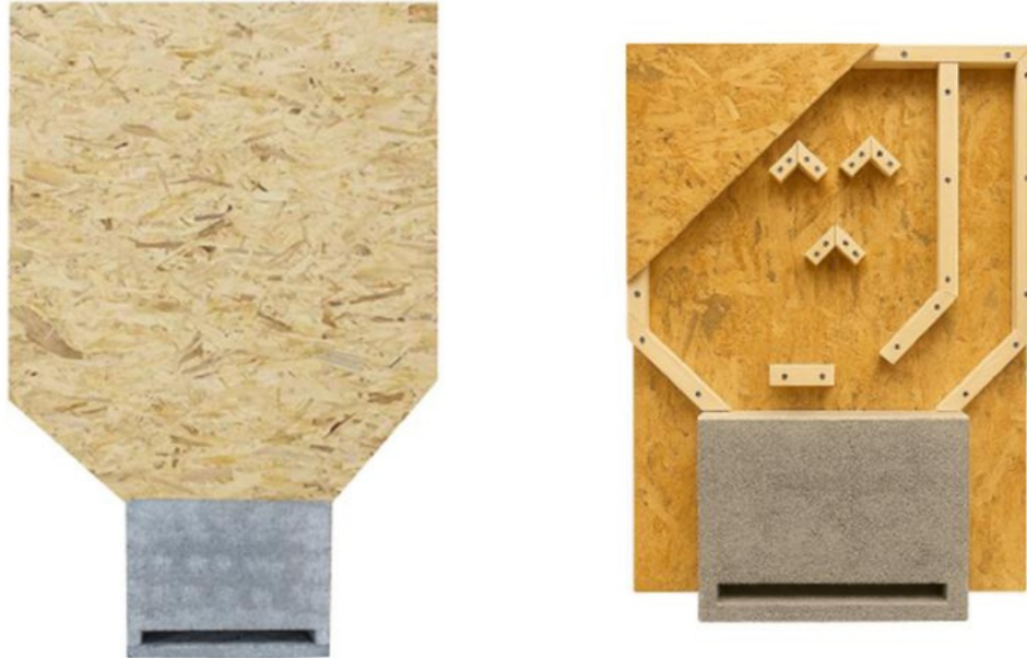
Figuur 2: Permanente kraamkasten Jivo VLKI 09. Deze kast is meerlaags en wordt uitgevoerd als ca. 80 centimeter bij ca. 50 centimeter en met lagen van minimaal 2.1 centimeter diep. De kast wordt in de spouw geïntegreerd. Door de trechtervormige vormgeving wordt ophoping van uitwerpselen voorkomen, waardoor de voorziening zelfreinigend is.
