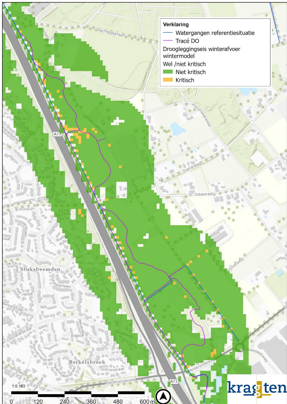
Figuur 18 Droogleggingseis o.b.v. eisen waterschap en referentiegrondgebruiksaan voor de drooglegging tijdens een winterafvoer in het wintermodel voor het DO.
