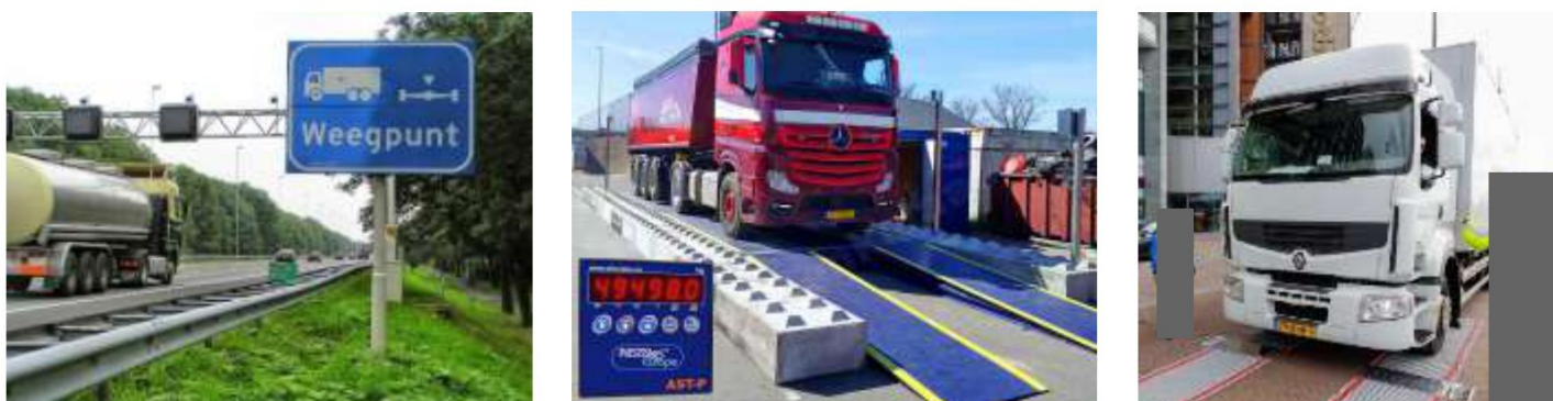
Figuur 7: een mobiel weegstelsel voor controle op locatie of een weegbrug op afstand zijn denkbaar voor handhaving. Een weegstelsel in het wegdek is niet betrouwbaar genoeg.
