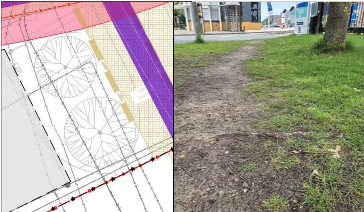
Afbeelding 12: Ligging kabels en leiding t.o.v. boom 6 en 7 Afbeelding 13; oppervlakkige wortels en verdichte ondergrond.
