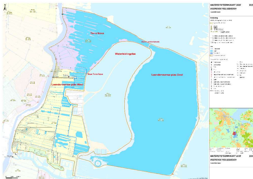
Figuur 1 Watersysteemkaart polder Loenderveen. In rood de namen van de deelgebieden en relevante stuwen ter verduidelijking.
