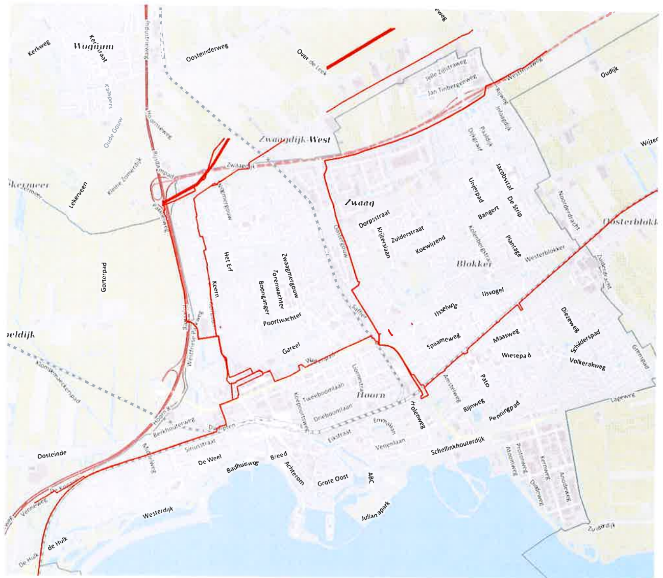
Figuur 6: (ondergrondse) hoogspanningskabels en (bovengrondse) hoogspanningslijnen. De (bovengrondse) hoogspanningslijnen zijn aangeduid met de dikkere lijn.
