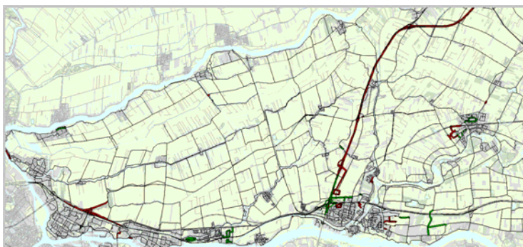
Figuur 6.1: Overzicht wijzigingen in wettelijke snelheden en nieuwe wegvakken 2030 ten opzichte van 2015 (rood nieuw of toename en groen afname wettelijke snelheid)
