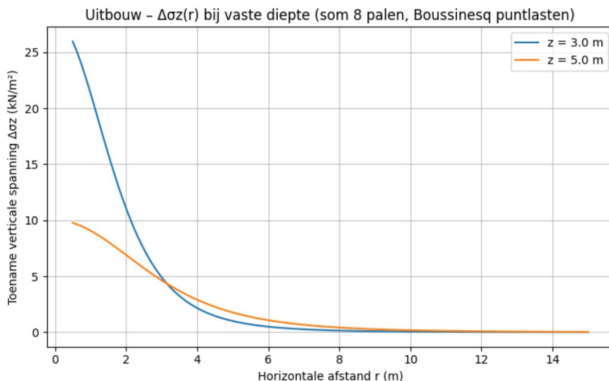
Figuur 6.1: Verticale spanningsverhoging \Delta\sigma_z als functie van de horizontale afstand r bij vaste dieptes z = 3,0 m en z = 5,0 m ten gevolge van de paalfundering van het bijgebouw. De spanningsverhoging is bepaald met de Boussinesq-oplossing voor puntlasten, uitgaande van een conservatieve effectieve belasting van Q = 65,5 kN per paal en een lineaire sommatie van acht palen. De figuur laat zien dat de spanningsbijdrage sterk afneemt met toenemende afstand en voor relevante afstanden tot de teenslijn van de regionale waterkering beperkt blijft.
