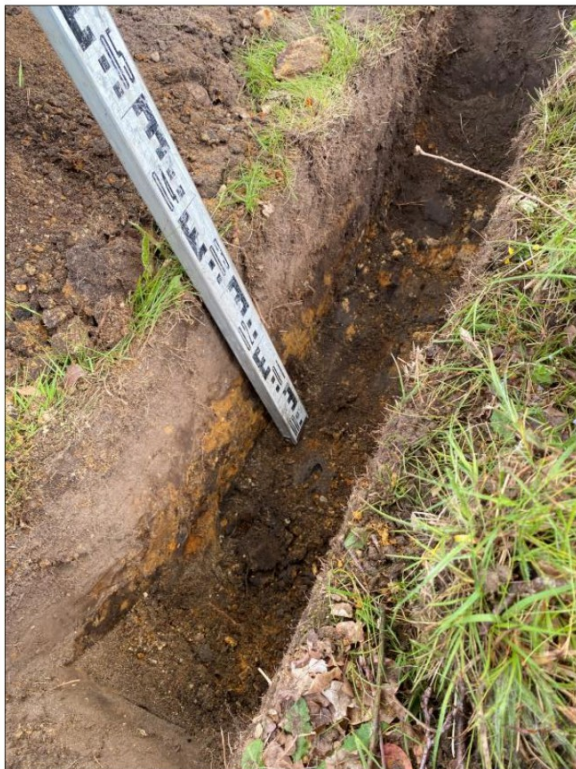
Afbeeldingen 14 en 15: Proefsleuf ter hoogte van de voorgenomen ontgraving (paars) bij boom 2. Er zijn hier geen stabiliteitswortels aangetroffen. Dit sluit niet uit dat buiten de proefsleuf wel stabiliteitswortels aanwezig kunnen zijn.
