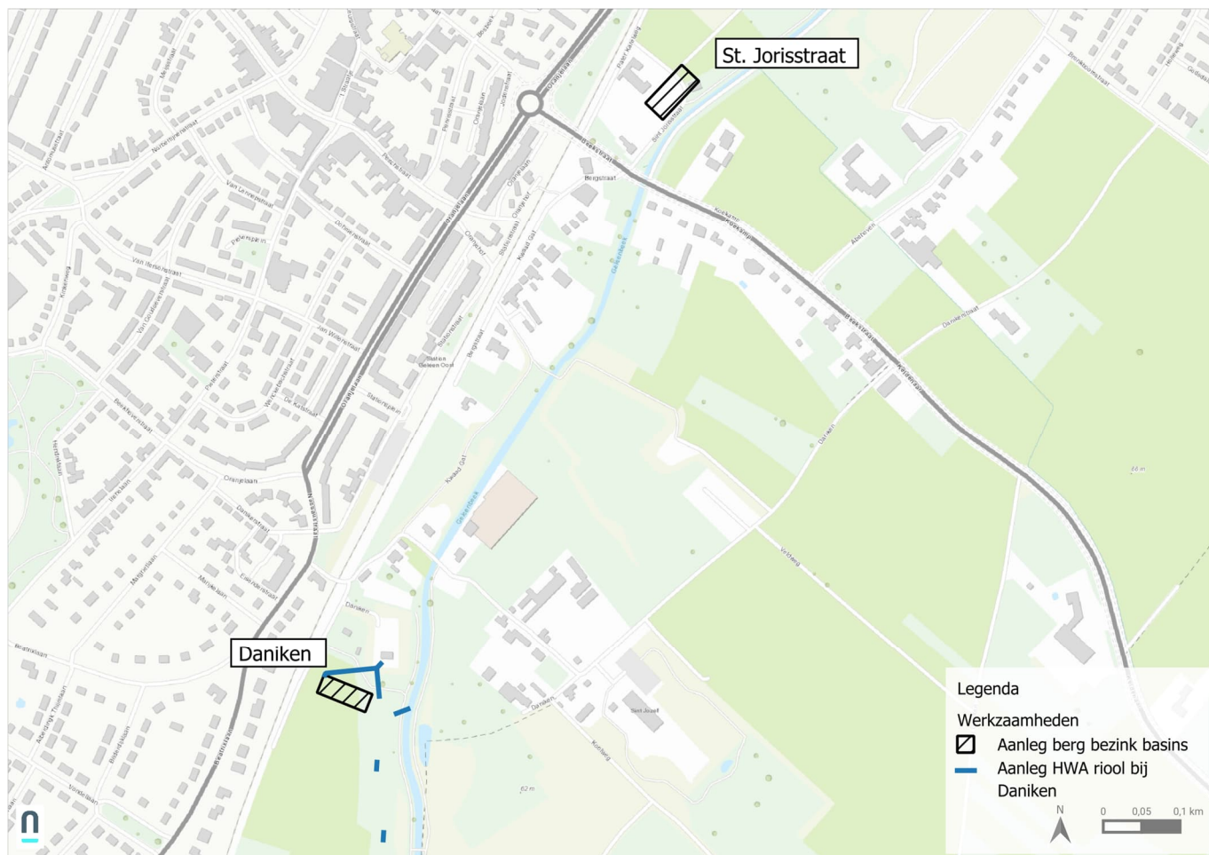
Figuur 1: Overzicht werkzaamheden. In de figuur is het VWA riool bij de projectlocatie Daniken nog niet gepresenteerd aangezien de ligging hiervan nog nader wordt bepaald.
