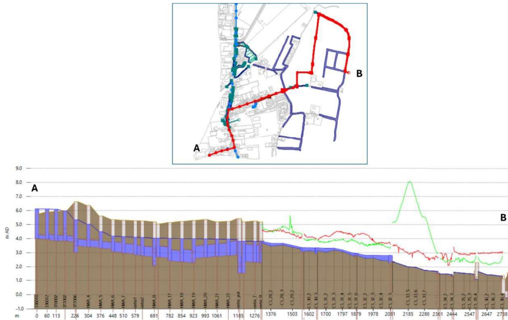
Figuur 4-4 Lengteprofiel van de Smoorstraat (A), via de Gastelseweg en de Buijensstraat naar de duiker onder de Nelson Mandelaweg (B). Dit is de maximale waterstand bij een Bui 10.
