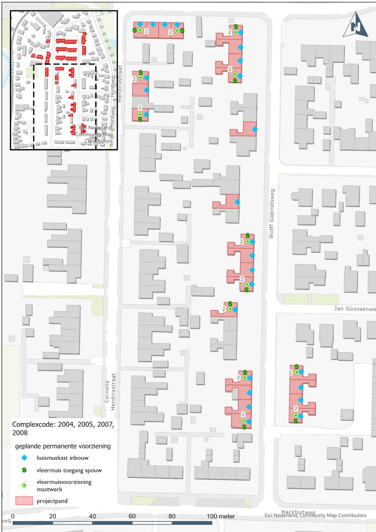
Figuur 8: Geplande locaties permanente voorzieningen in het zuidelijke deel van het projectgebied. Toegang spouw betreft een open zolderspouw van minimaal 8 m 2 en 3 cm diep met toegang via kantpannen. Maatwerk betreft een geschikt gemaakte zijde van het dakvlak (30 m 2 ) met toegang via schoorsteen als een geschikte schoorsteen aanwezig is, en toegang via kantpannen op kopgevels.
