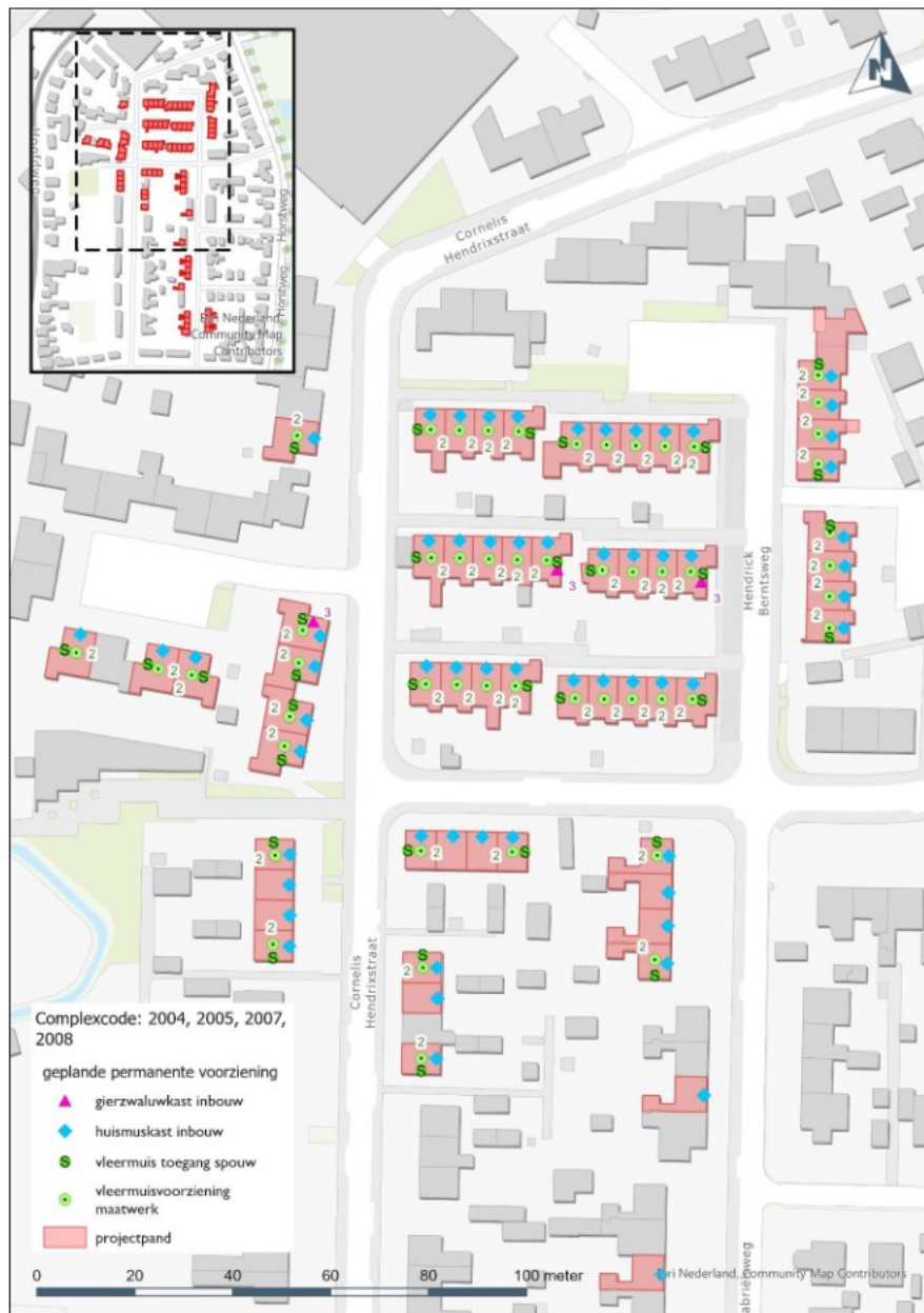
Figuur 7: Geplande locaties van de permanente voorzieningen in het noordelijke deel van het projectgebied. Toegang spouw betreft een open zolderspouw van minimaal 8 m 2 en 3cm diep met toegang via kantpannen. Maatwerk betreft een geschikt gemaakt zijde van het dakvlak (30 m 2 ) met toegang via de schoorsteen als er een geschikte schoorsteen aanwezig is, en toegang via kantpannen op kopgevels.
