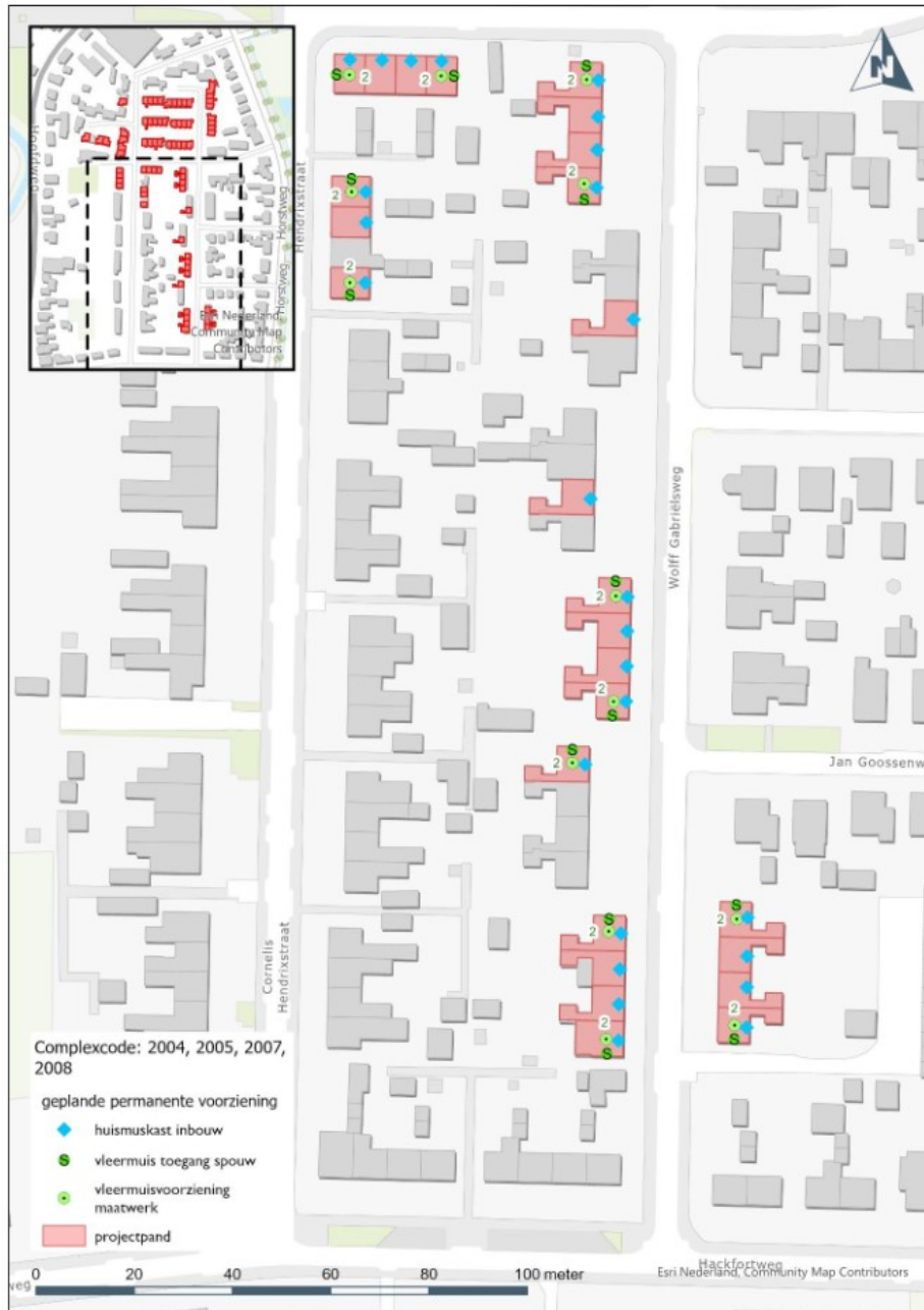
Figuur 8: Geplande locaties van de permanente voorzieningen in het zuidelijke deel van het projectgebied. Toegang spouw betreft een open zolderspouw van minimaal 8 m 2 en 3cm diep met toegang via kantpannen. Maatwerk betreft een geschikt gemaakt zijde van het dakvlak (30 m 2 ) met toegang via de schoorsteen als er een geschikte schoorsteen aanwezig is, en toegang via kantpannen op kopgevels.
