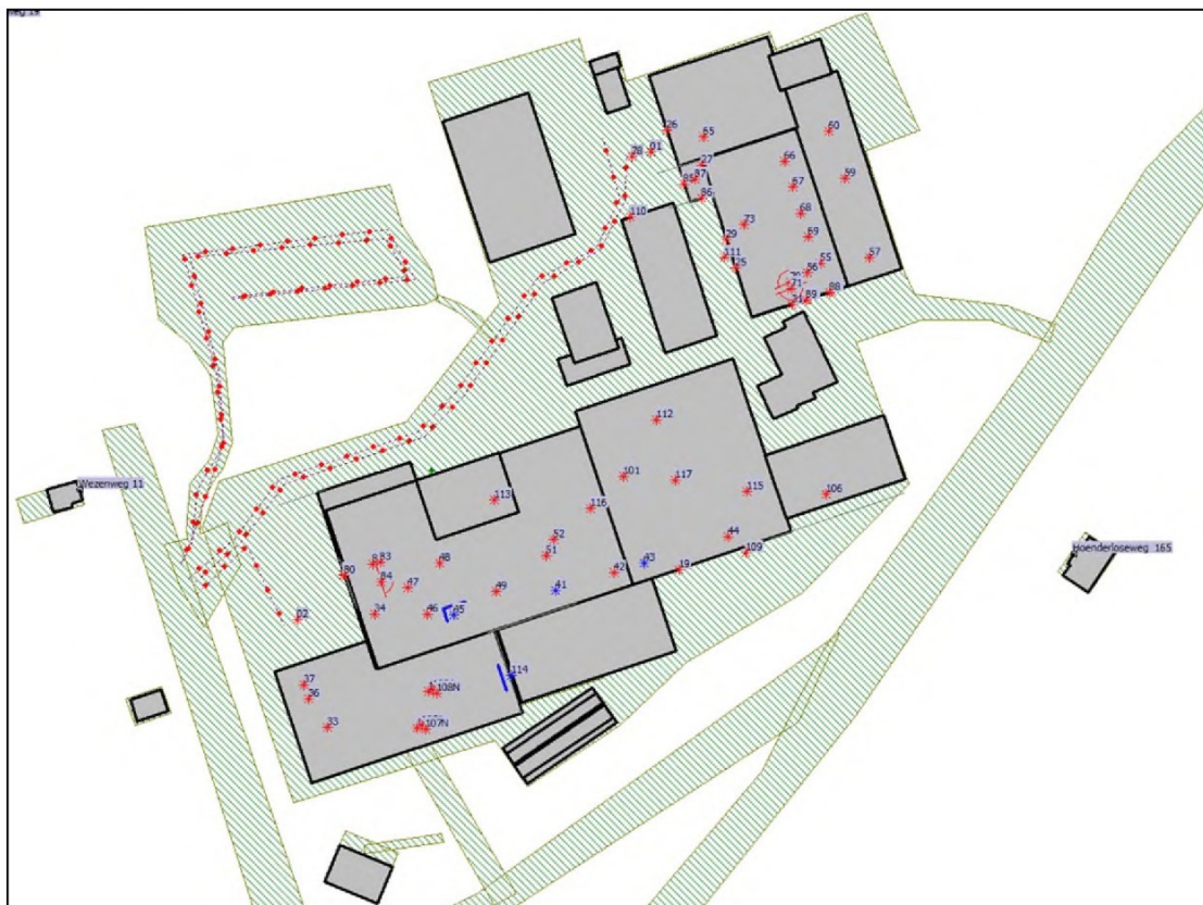
Figuur 5.1 Mogelijke te treffen maatregelen bij VHP (blauwe bronnen zijn de bronnen waar maatregelen nodig zouden zijn om te voldoen aan de vergunde waarden)
