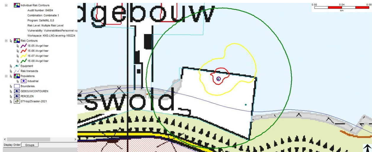
Figuur 6: Risico-contouren LNG-levering
