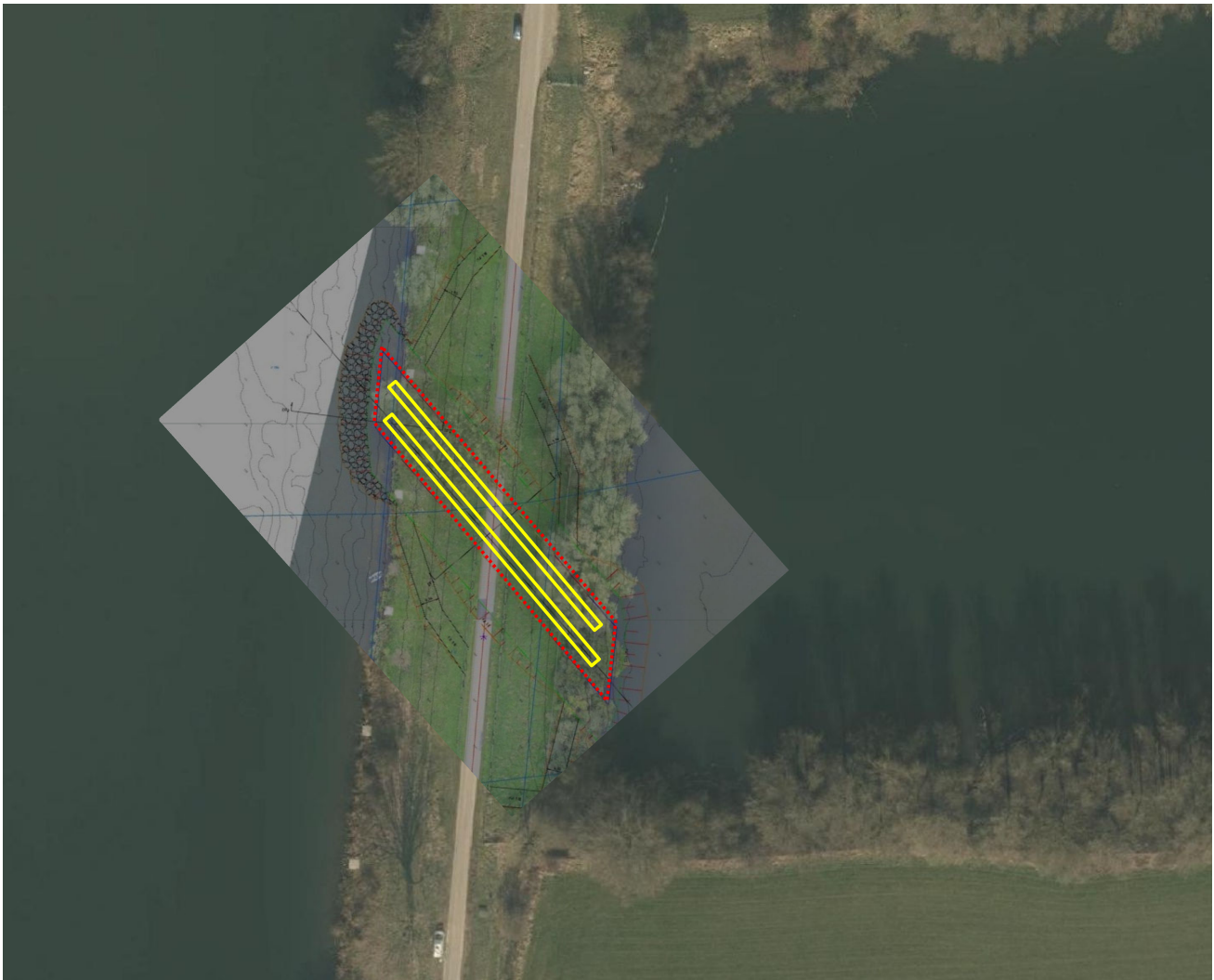
Figuur 1-2 Bovenaanzicht plan, met in geel de kokerduikers en in rood de damwanden
