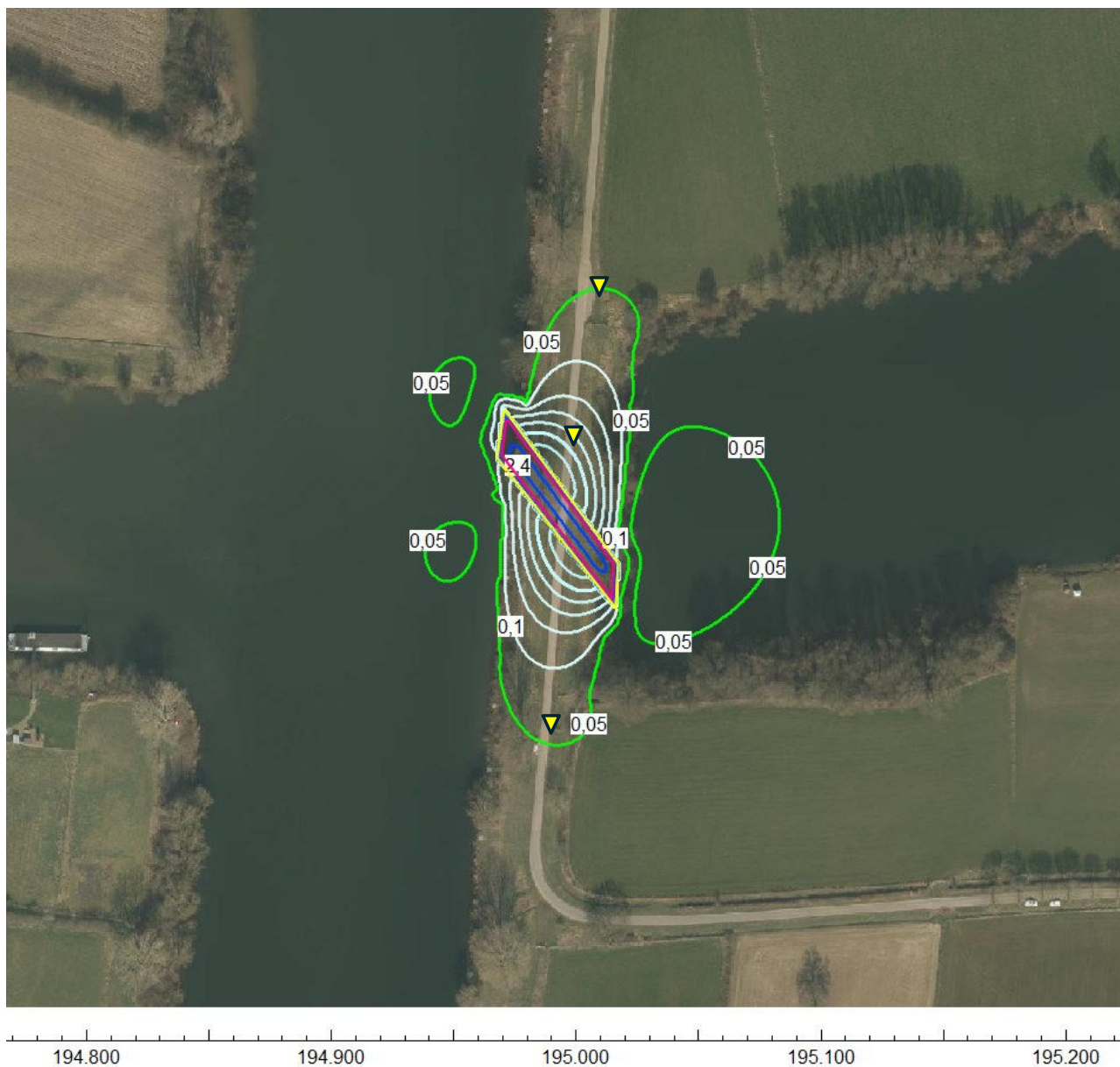
Figuur 4-1 Principetekening met locaties monitoringspeilbuizen voor de omgevingseffecten (geel)
