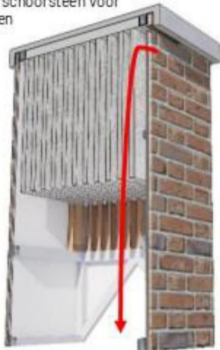
Figuur 6: Verblijfplaats voor vleermuizen in de schoorsteen.
