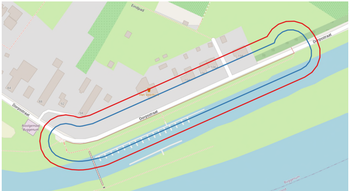
Figuur 4-1 Risicocontouren met een overschrijdingskans van 5% (blauw) en 1% (rood) bij een indicatieve meting voor bouwkundig normale gebouwen. Uit [5].
