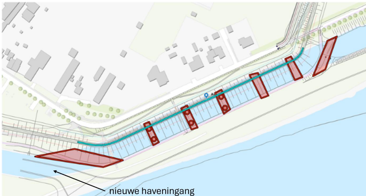
Figuur 1.2: Dammen die worden aangebracht in het langskanaal voor compartimentering van de werkzaamheden.
