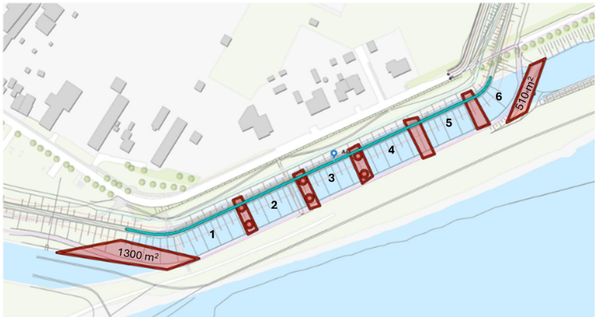
Figuur 2.2: Dammen die worden aangebracht in het langskanaal voor compartimentering van de werkzaamheden.
