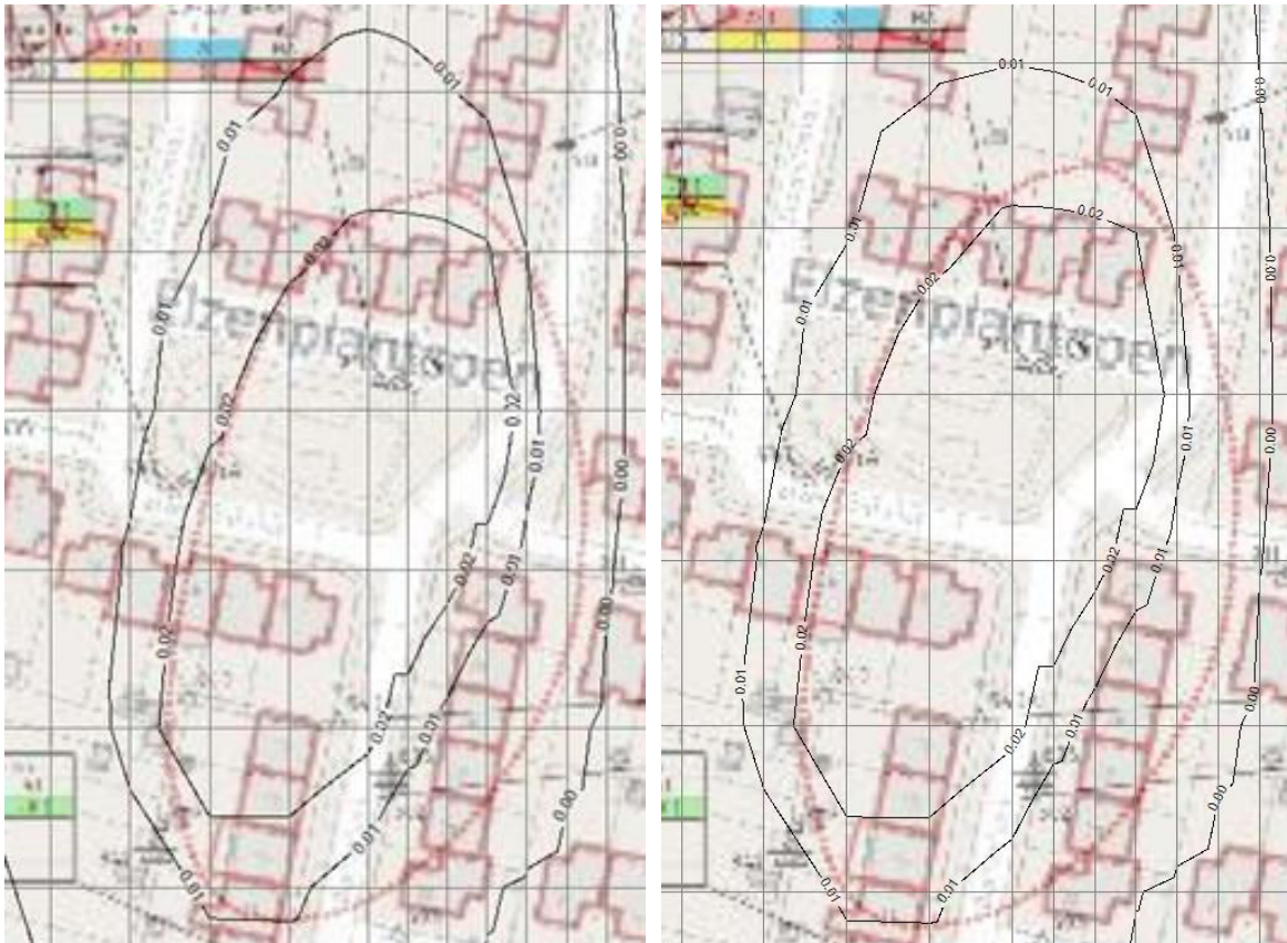
Figuur 4.8 Contouren grondwaterverontreiniging VOCL Ophoven Sittard laag 1 na 275 dagen bemaling (links) en in natuurlijke situatie (rechts)
