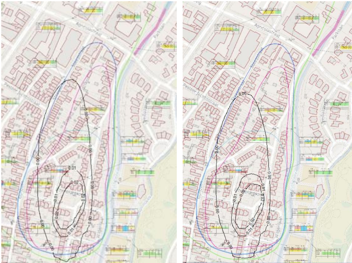
Figuur 4.7 Contouren grondwaterverontreiniging VOCL Ophoven Sittard laag 1 na 275 dagen bemaling (links) en in natuurlijke situatie (rechts)
