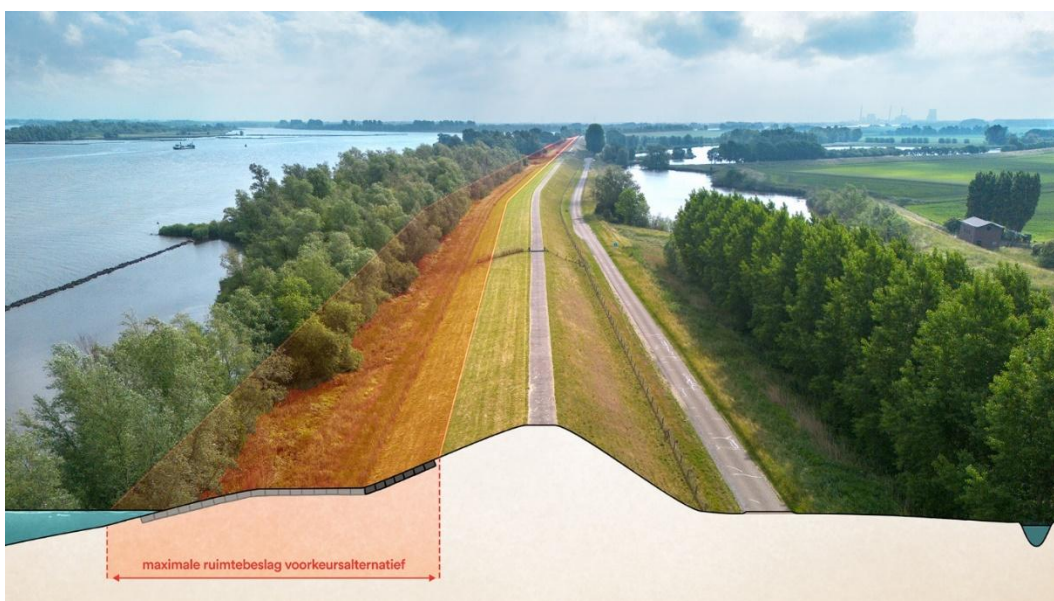
Figuur 6-5 Visualisatie oplossingsrichting en maximaal ruimtebeslag dijkvak 5
