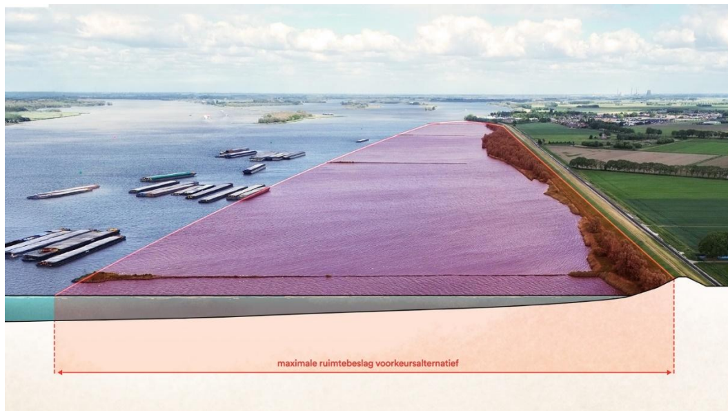
Figuur 6-3 Visualisatie oplossingsrichting en maximaal ruimtebeslag dijkvak 3
