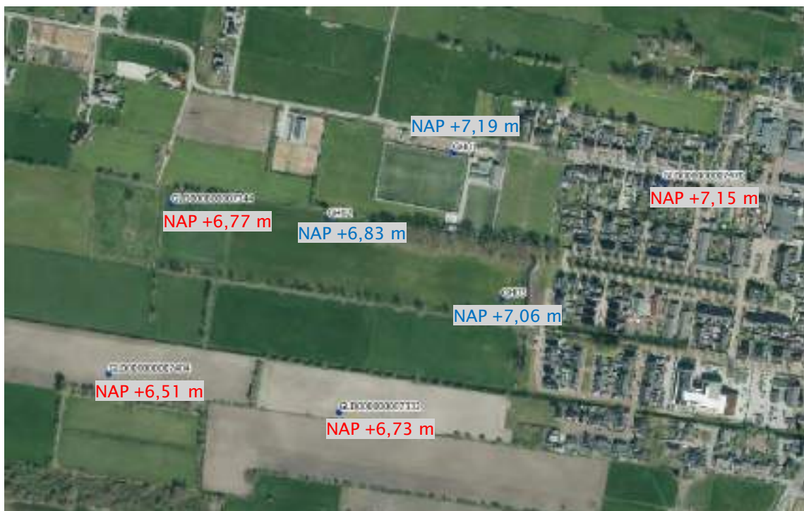
Figuur 5: Peilbuizen en RHG-waarden van Gemeente Ede en Waterschap Vallei en Veluwe met RHG-waarden rood (data beschikbaar via BROloket), en BOOT met RHG-waarden in blauw weergegeven.
