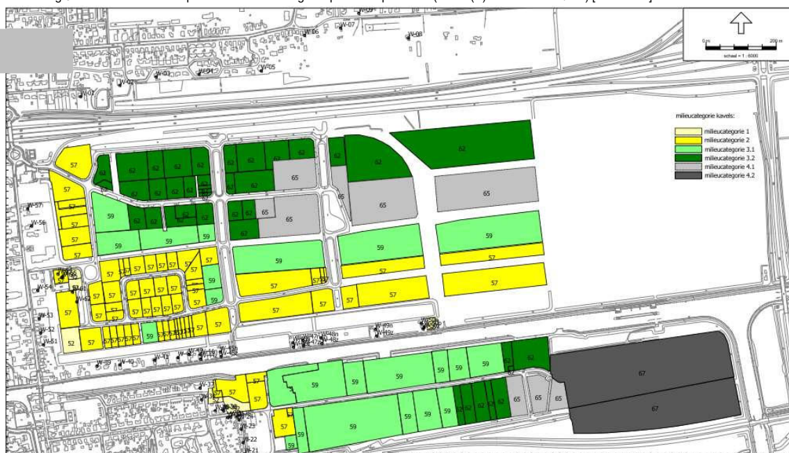
Afbeelding 3.2: akoestisch verdeelplan met toelaatbare geluidproductie per kavel ( L_w dB(A) etmaalwaarde/ m 2 ) [bron: nota]
