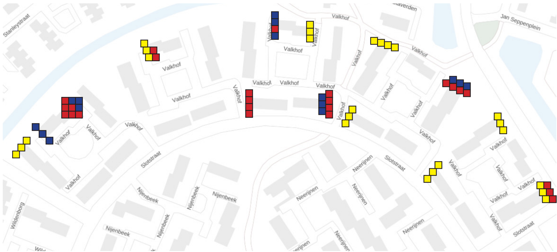
Afbeelding 16: Kaart van De Valkhof met daarop de nieuwe aan te brengen en in te bouwen voorzieningen aangegeven. In rood inbouwkasten voor vleermuizen, in donkerblauw inbouwkasten voor gierzwaluwen en in geel tijdelijke nestkasten voor huismus.
