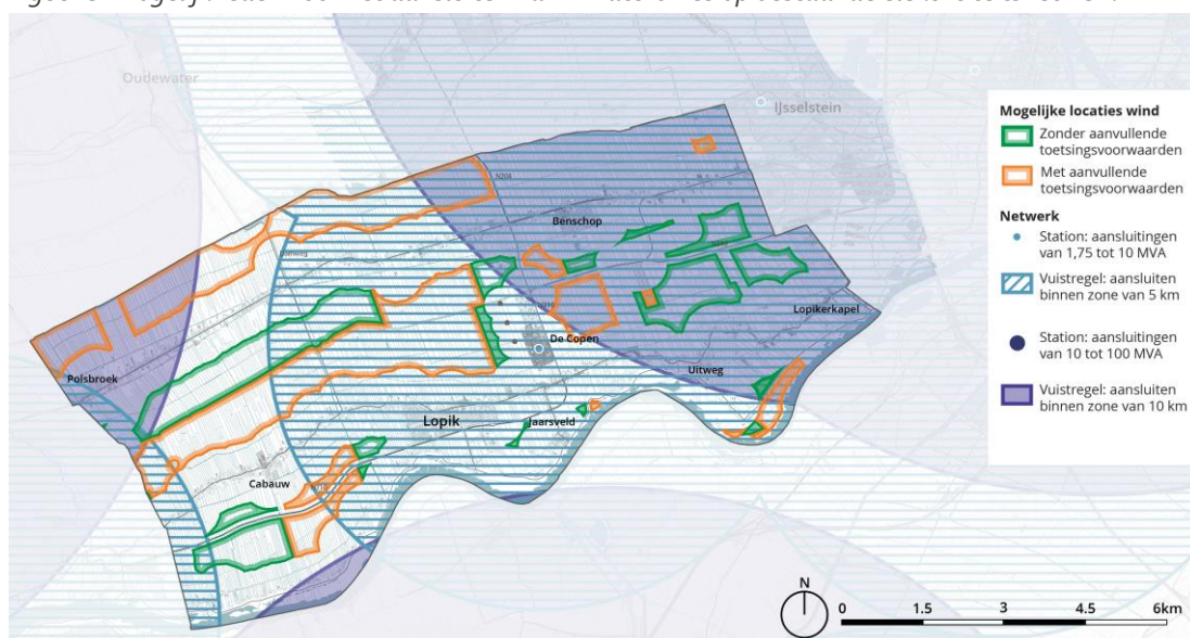
Figuur 5: Mogelijkheden voor het aansluiten van windturbines op bestaande elektriciteitsnetwerk
