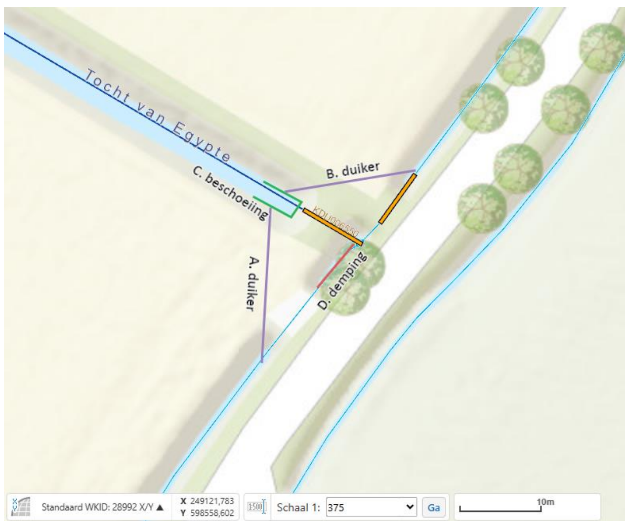
Figuur 1: Overzichtstekening van de werkzaamheden. De paarse lijnen geven de aan te leggen duikers (A & B) weer. De groene lijn (C) geeft de locatie van de te plaatsen beschoeiing weer. De rode lijn (D) geeft het te dempen oppervlaktewaterlichaam weer.
