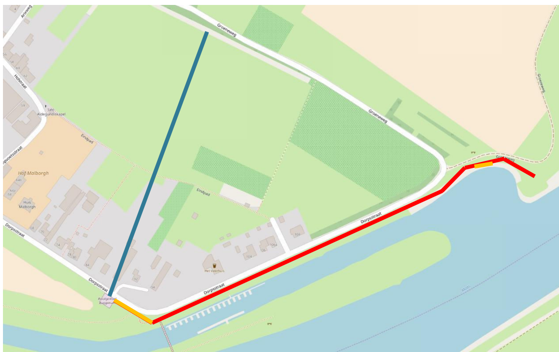
Afbeelding 1: Schematisch in rood het bestaande Tracé en in blauw het nieuwe tracé. In werkelijkheid zit hier een lichte bocht in. De oranje delen worden verwijderd.
