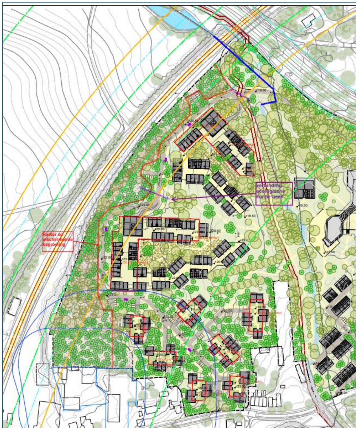
Figuur 4-4 Uitsnede van de westzijde van het plangebied met Inrichtingsmaatregelen voor het leefgebied van de das. De rode lijn aan de westzijde van het plangebied vormt het voorlopige ontwerp van het te plaatsen raster. Tussen de plangrens en het raster worden de maatregelen genomen om het leefgebied te versterken. De twee blauwe gestreepte lijnen vormen de toekomstige buizen die door onder andere das gebruikt kunnen worden als verbinding tussen verblijfplaats en beek (ZUS, 2023).
