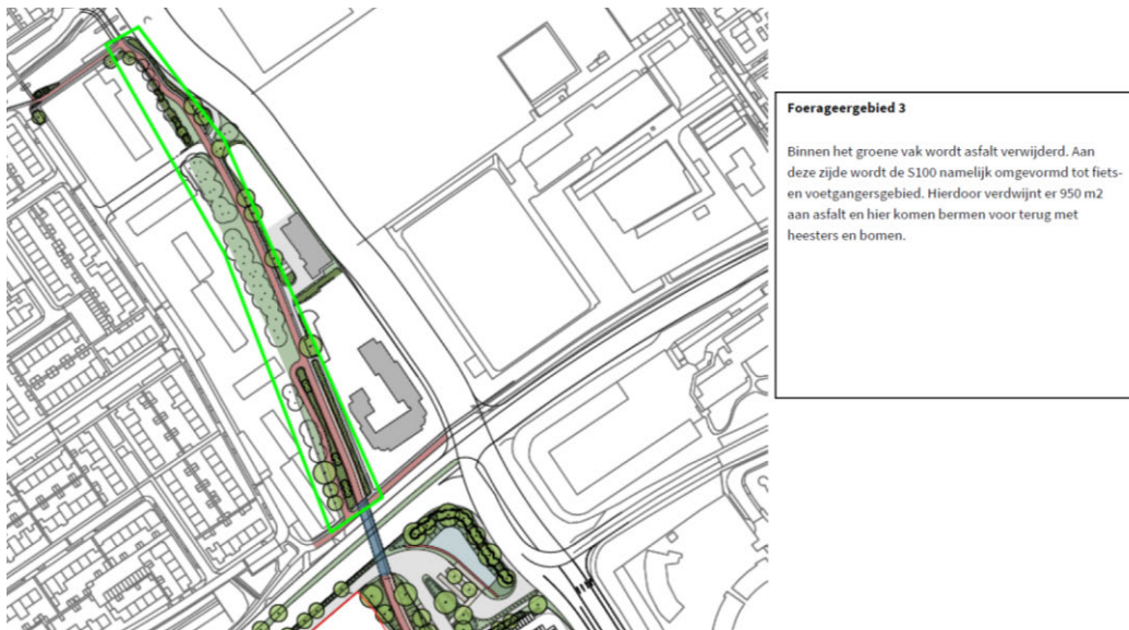
Figuur 5: Op deze locatie wordt asfalt verwijderd en wordt 950 vierkante meter groenvoorziening gerealiseerd.
