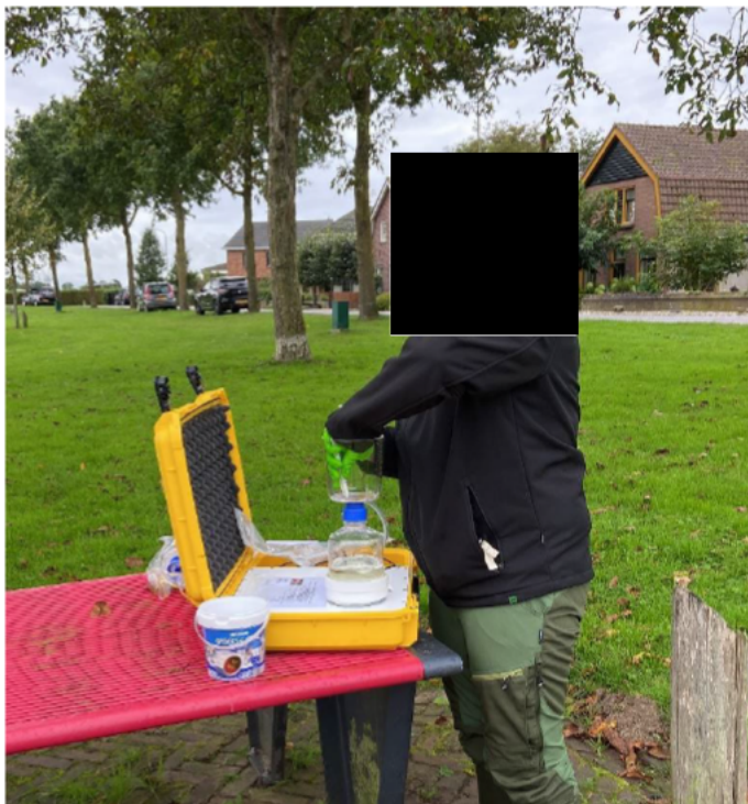
Afbeelding 6. Veldmedewerker conserveert het filter door deze in delen in een buis te doen met conserveringsmiddel zodat het eDNA niet afbreekt.
