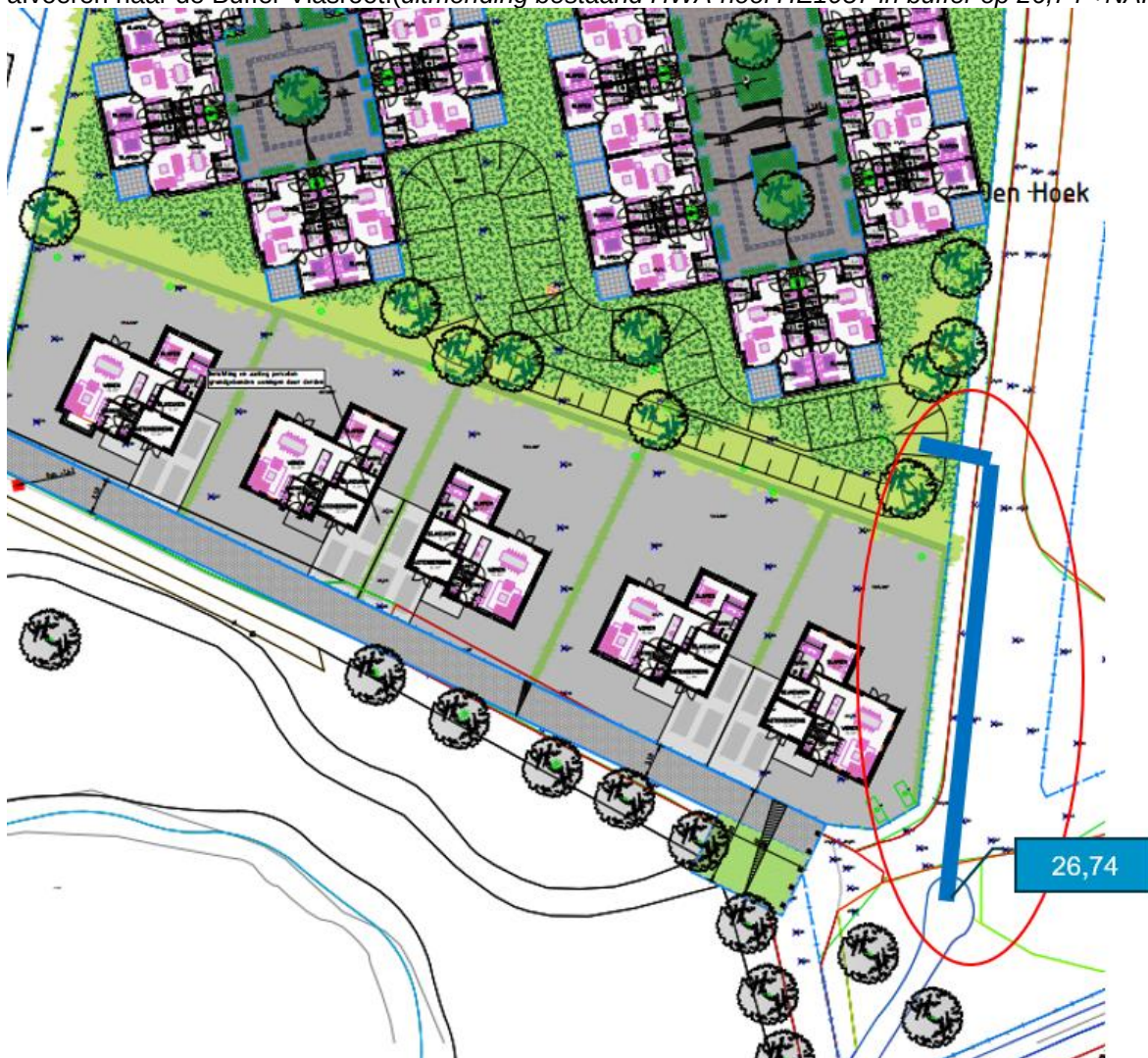
Schetsmatige weergave leegloopvoorziening en noodoverlaat Wadi
