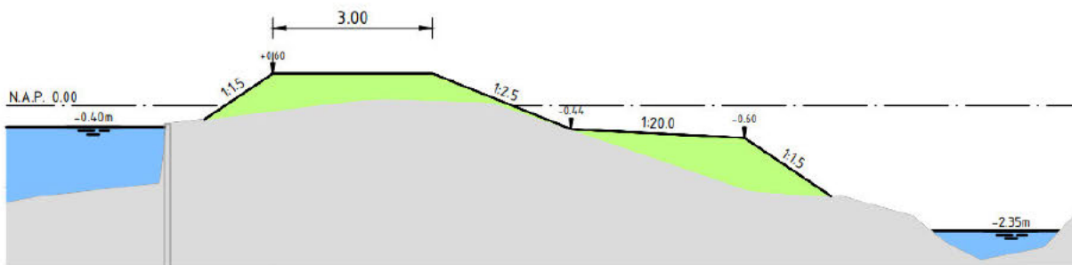
Figuur 4-5 Ontwerp dijkverbetering dijkvak 4 (m657)
