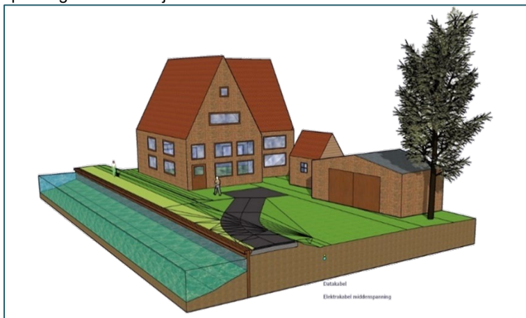
Figuur 5-36: Principeschets kansrijke alternatief 15.2 “Hoogtescherp in de oever”
