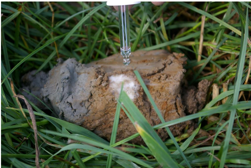
Afbeelding 14 Kalk in reactie met zoutzuur
