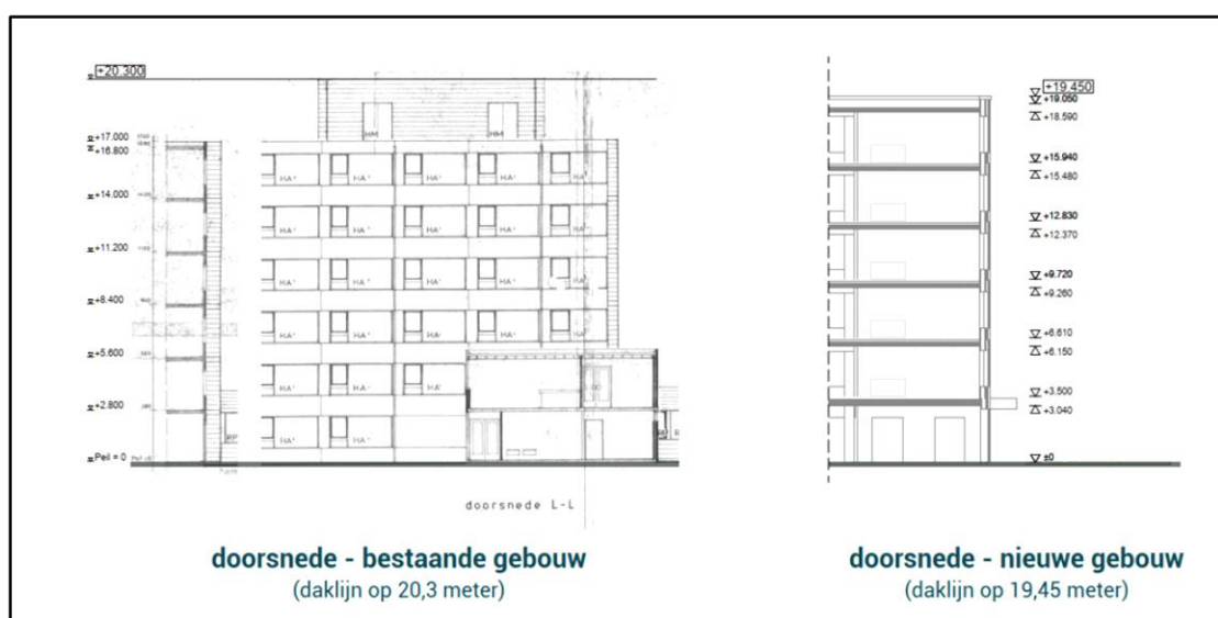
Afbeelding 5: Dwarsdoorsnedes dakopbouw en huidige situatie
