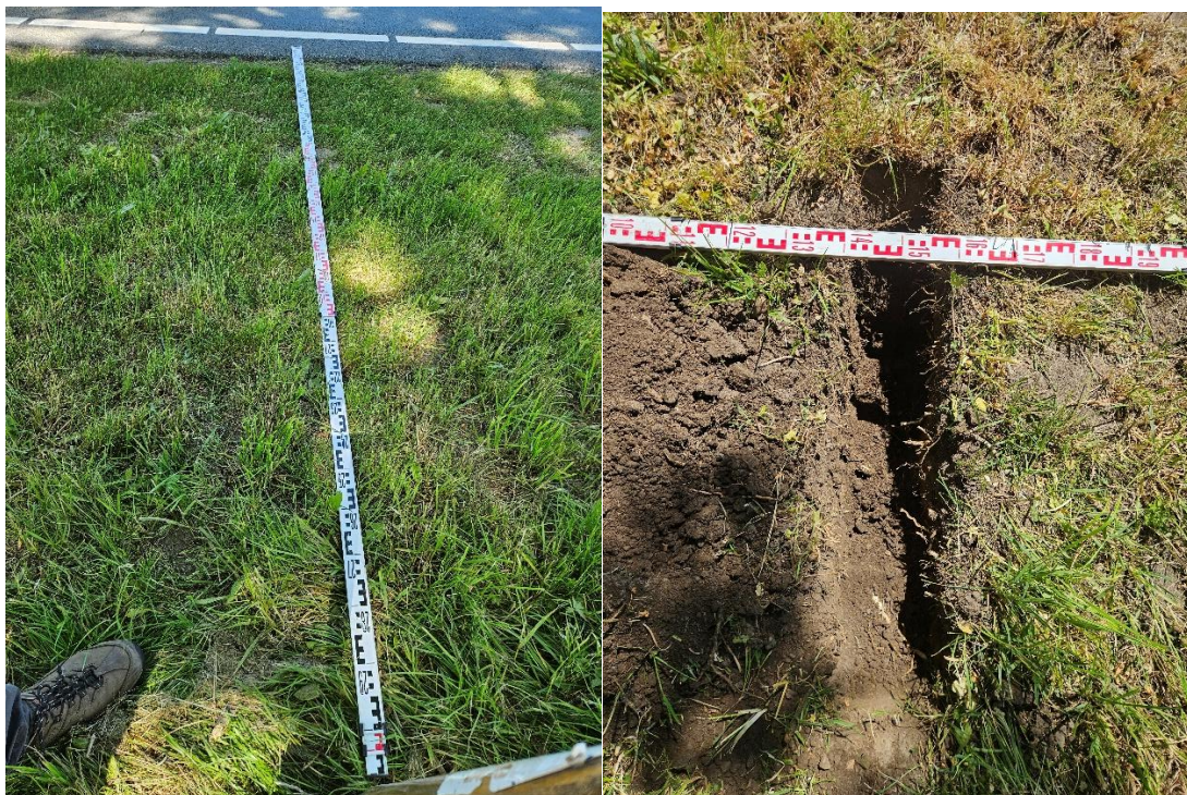
Afbeelding 10 en 11: proefsleuf 2 bij boom 11, te snoeien wortels tot 3cm dikte op rand van de verbreding. Ook hier is wortelsnoei met behoud van de bomen mogelijk.
