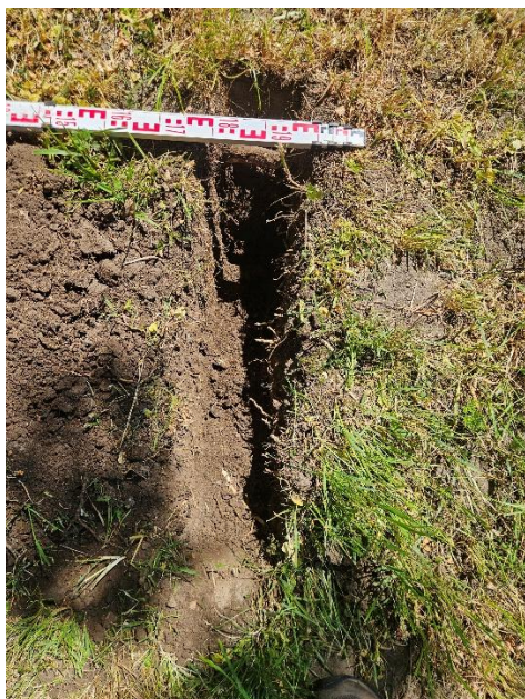
Afbeelding 9: Proefsleuf 1, wortels tot 3cm dikte op de rand van het fietspad, deze zijn met behoud van de boom vakkundig te snoeien.
